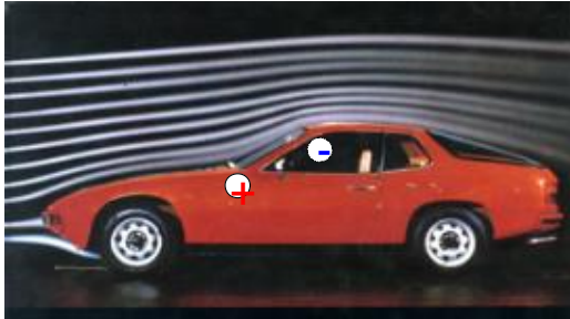
Görbült áramvonalak személyautó körül 12.3 ábra
