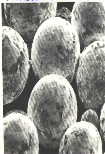
Abb. 7 Porózus szinterbronz Vergrößerung 80fach szűrésű f.: 1-5 µm 1. ábra
