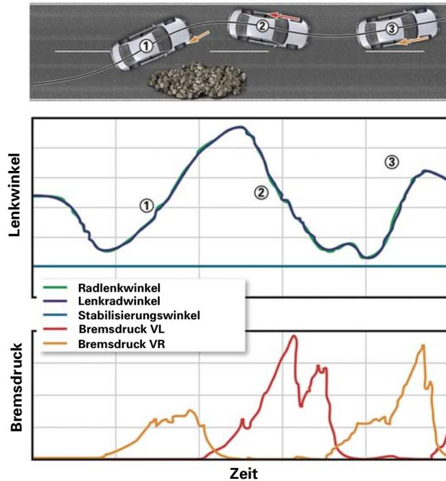
Mit der Dynamiklenkung erfolgt das stabilisierende Gegenlenken automatisch und vom Fahrer unbemerkt. Dadurch reduziert sich der Lenkaufwand des Fahrers deutlich.
