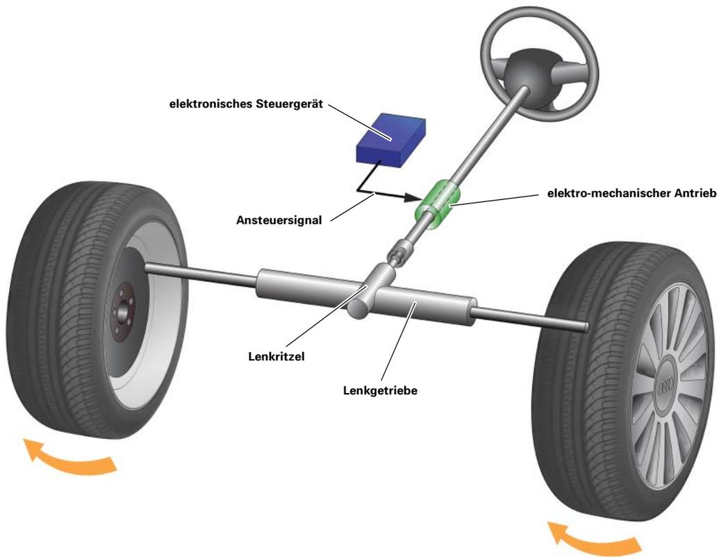
Die Vorteile der Dynamiklenkung sind jedoch noch wesentlich umfangreicher. Im Zusammenspiel mit dem ESP und seinen Sensoren wird das System auch bei drohenden kritischen Fahrzuständen aktiv. Durch gezielte Variation des Lenkeinschlages der Vorderräder unterstützt die Dynamiklenkung das ESP im fahrdynamischen Grenzbereich.
