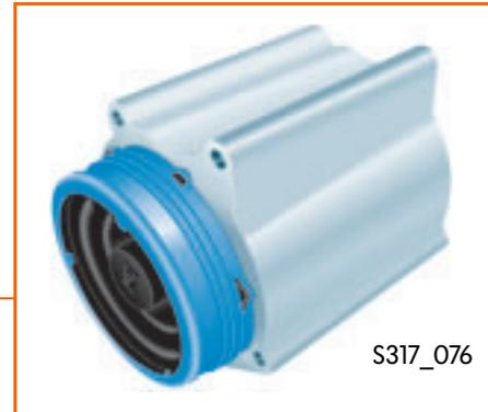
Der Elektromotor V187 ist ein bürstenloser Asynchron-Motor. Er entwickelt ein maximales Drehmoment von 4,1 Nm zur Unterstützung der Lenkung.
