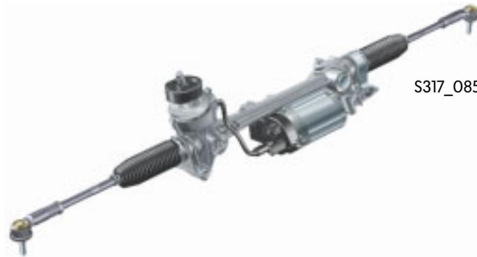
Das Lenkgetriebe besteht aus dem Geber für Lenkmoment, einem Torsionsstab, einem Lenk- und Antriebsritzel, einem Schneckengetriebe sowie dem Elektromotor mit dem Steuergerät. Kernstück der elektro-mechanischen Servolenkung ist eine Zahnstange mit zwei Verzahnungen im Lenkgetriebe.
