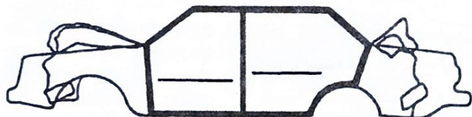
56. ábra. Biztonsági kocsitest deformációja, frontális ill. ráfutásos ütközés esetén.
