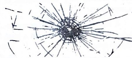
65. ábra. Több rétegű ragasztott biztonsági üveg.
