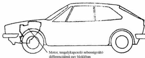
1. 10 ábra Elsőkerék hajtás (fronthajtás), a motor keresztirányú elrendezésű, a hajtásblokk súlypontja az első tengely fölött
