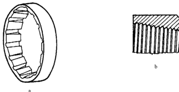
3. 40 ábra Szinkrongyűrűk kúpfelületeinek konstrukciós változatai a) bordás, b) recézett
