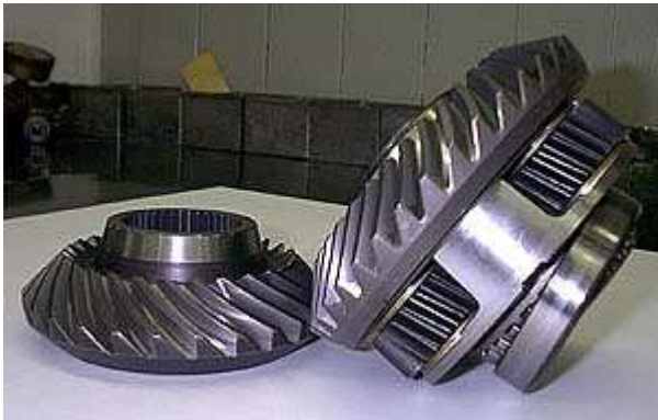
A hajtás 90°-os elfordításáért felelős fogaskerék-pár, az összetett darab a bolygókerék
