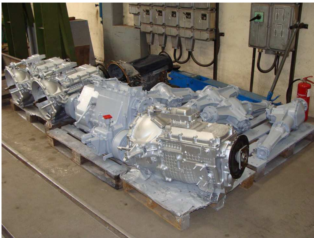
2. kép: BTR-80 erőátviteli fődarabok (sebességváltó, osztómű, hajtóhíd)
