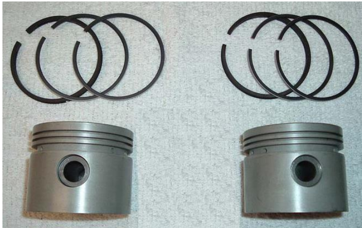
17.22 ábra Dugattyú „V” gyűrűs tömítéssel
