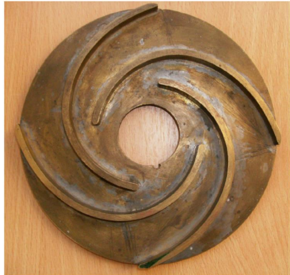
5-lapátos radiális átömlés járókerék rajza, be- és kilépési háromszögek, örvénymentes beömlés, bronz járókerék képe
