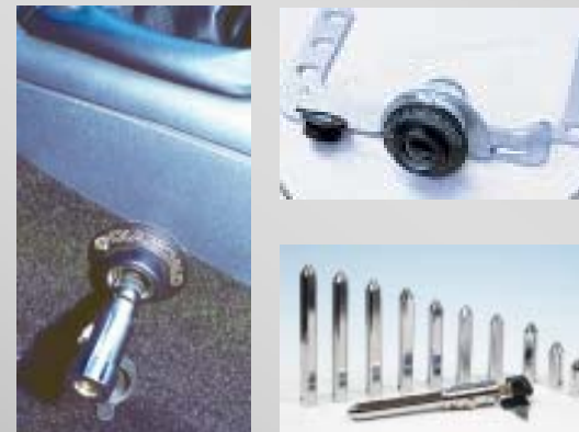
2.9.ábra: Zár kívülről (balra), Tartókonzol és a persely (fent jobbra), Acélcsapok különböző típusú váltókhoz (lent jobbra)
