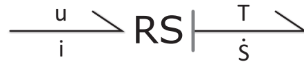
Abb. 5.49.: Widerstandsquelle: Die elektrische Leistung P = u \cdot i wird irreversibel in Wärme umgewandelt
